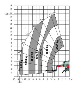
Máquina sobre estabilizadores rebajados con plumín de 1500 kg con cabrestante (sistema métrico) Máquina sobre estabilizadores bajados con gancho 5000 kg (Métrico)
