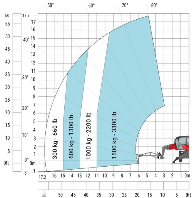
Machine on lowered stabilisers with hook 5000 kg (Metric) Drehung an abgesenkten Stützen mit 365 kg Arbeitskorb
