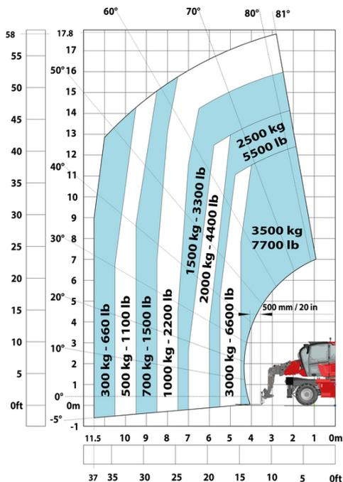
Drehung mit abgesenkten Stützen mit Gabeln
