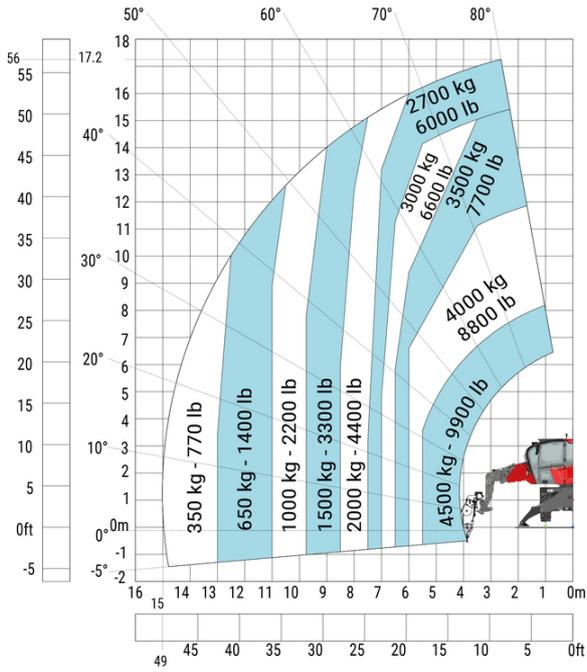
Drehung an abgesenkten Stützen mit 1500 kg Ausleger
