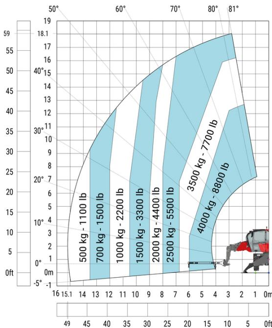
Machine sur stabilisateurs abaissés avec puissance-treuil de 1500 kg (Métrique)
