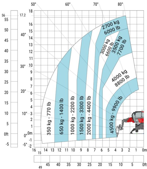
Machine sur stabilisateurs abaissés avec puissance 1500 kg
