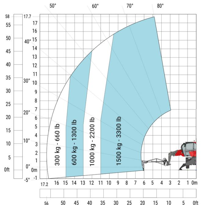
Machine sur stabilisateurs abaissés avec puissance 4000 kg (Métrique)
