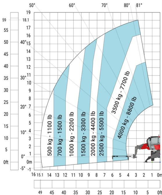
Macchina su stabilizzatori abbassati con braccio da 1500 kg con verricello (Metrico)
