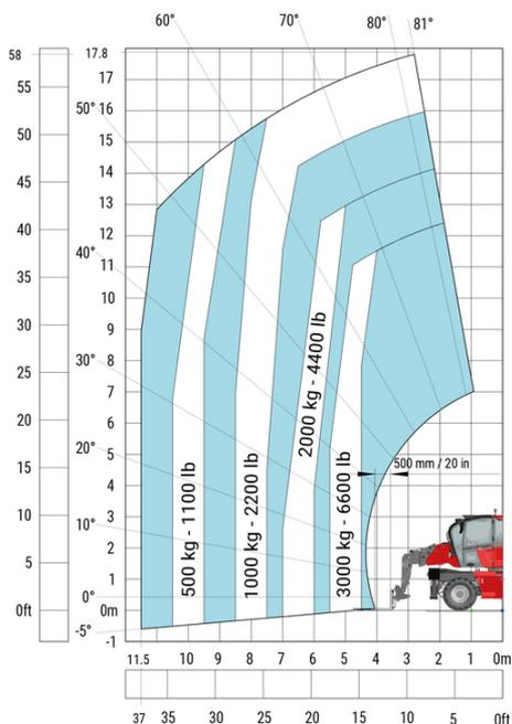
Drehung mit abgesenkten Stützen mit Gabeln
