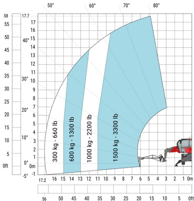
Machine on lowered stabilisers with hook 5000 kg (Metric) Drehung an abgesenkten Stützen mit 365 kg Arbeitskorb
