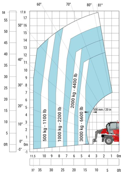
Rotación sobre estabilizadores bajados, con horquillas
