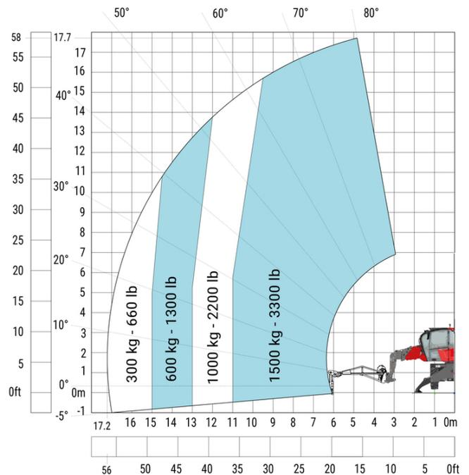
Machine on lowered stabilisers with hook 5000 kg (Metric) Rotación sobre estabilizadores bajados con plataforma de 365 kg
