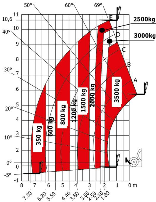
Machine sur pneus avec fourches - avec correcteur de dévers
