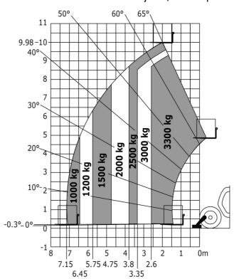
Máquina sobre estabilizadores con cesta para túneles (Metric)
