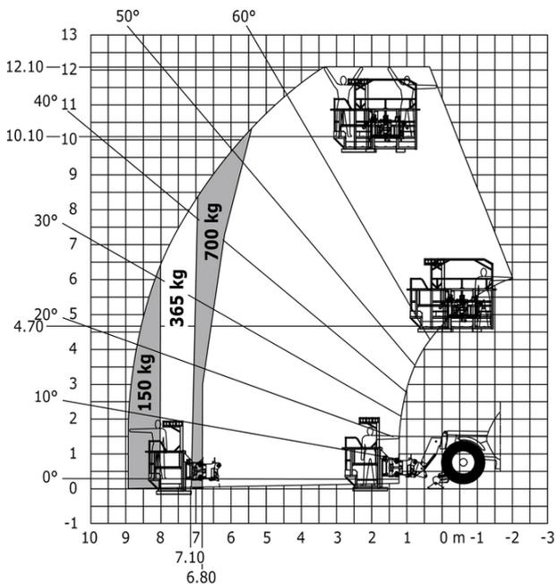
Máquina sobre estabilizadores con cesta minera subterránea (Metric)
