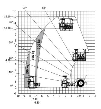
Máquina sobre estabilizadores con cesta minera subterránea (Metric)
