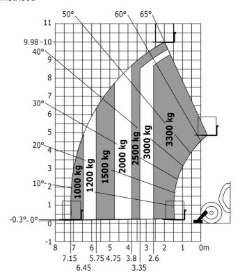
Máquina em estabilizadores com cesta para túneis (Metric) Máquina em estabilizadores com cesta para minas subterrânea (Metric)
