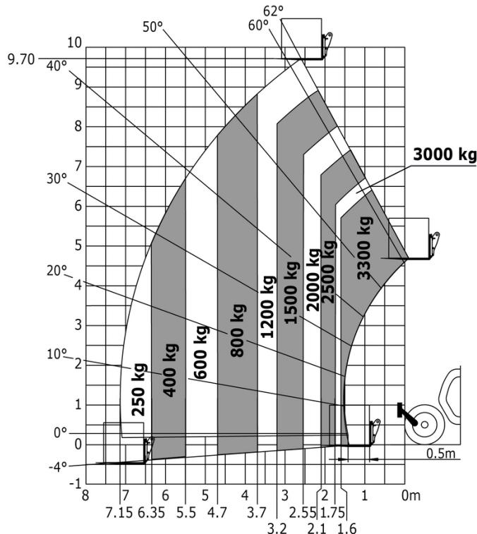
Машина на опущенных аутригерах с платформой для прокладки туннелей, метрическая система мер
