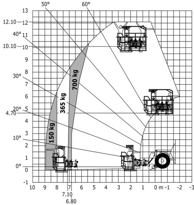
Машина при опущенных аутригерах с вилами - метрическая система мер
