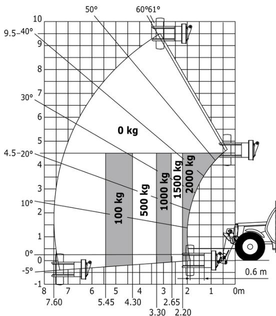
**Машина на опущенных аутригерах с захватом для шин малого диаметра TH 33, метрическая система мер**
