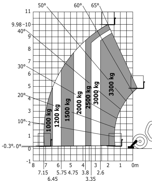
Máquina sobre pneus com manipulador de pneus finos TH 33 (Metric)    Máquina em estabilizadores com manipulador de pneus finos TH 33 (Metric)
