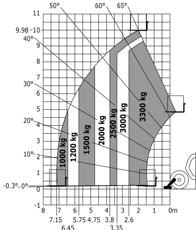
**Машина на шинах с захватом для шин малого диаметра TH 33, метрическая система мер**
