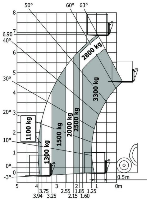
Machine sur pneus avec pince à pneu TH 33 (Métric)
