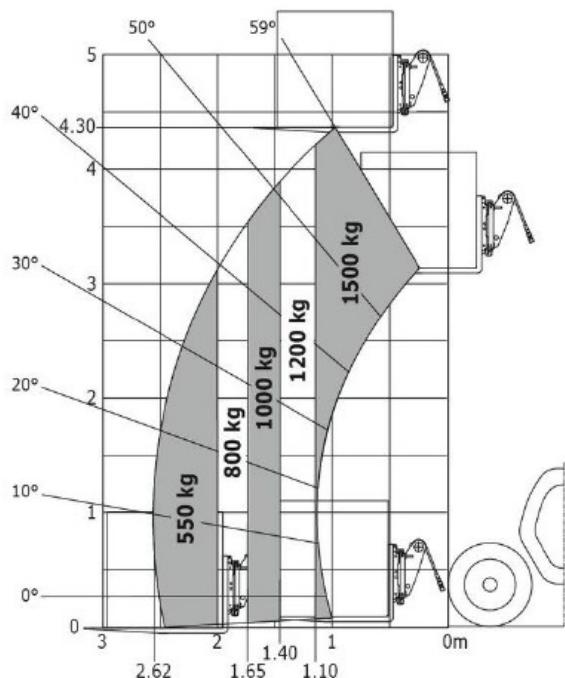
Maschine auf Rädern mit Gabelzinken LC 600 mm
