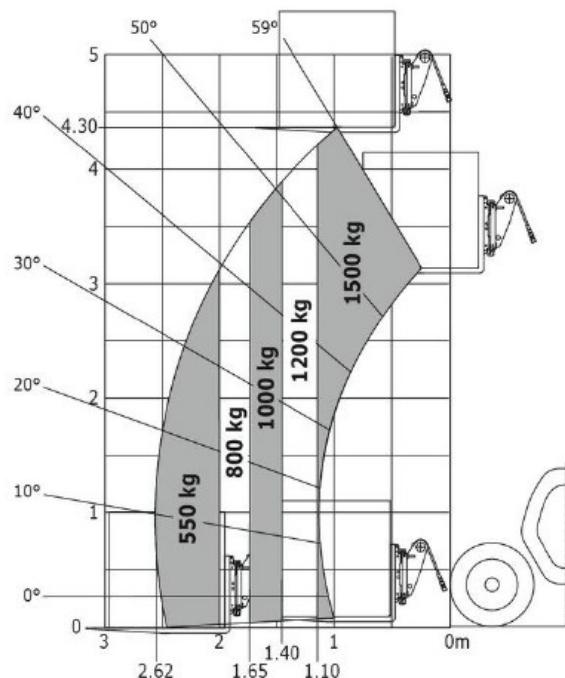
Máquina sobre pneus com garfos LC 600 mm
